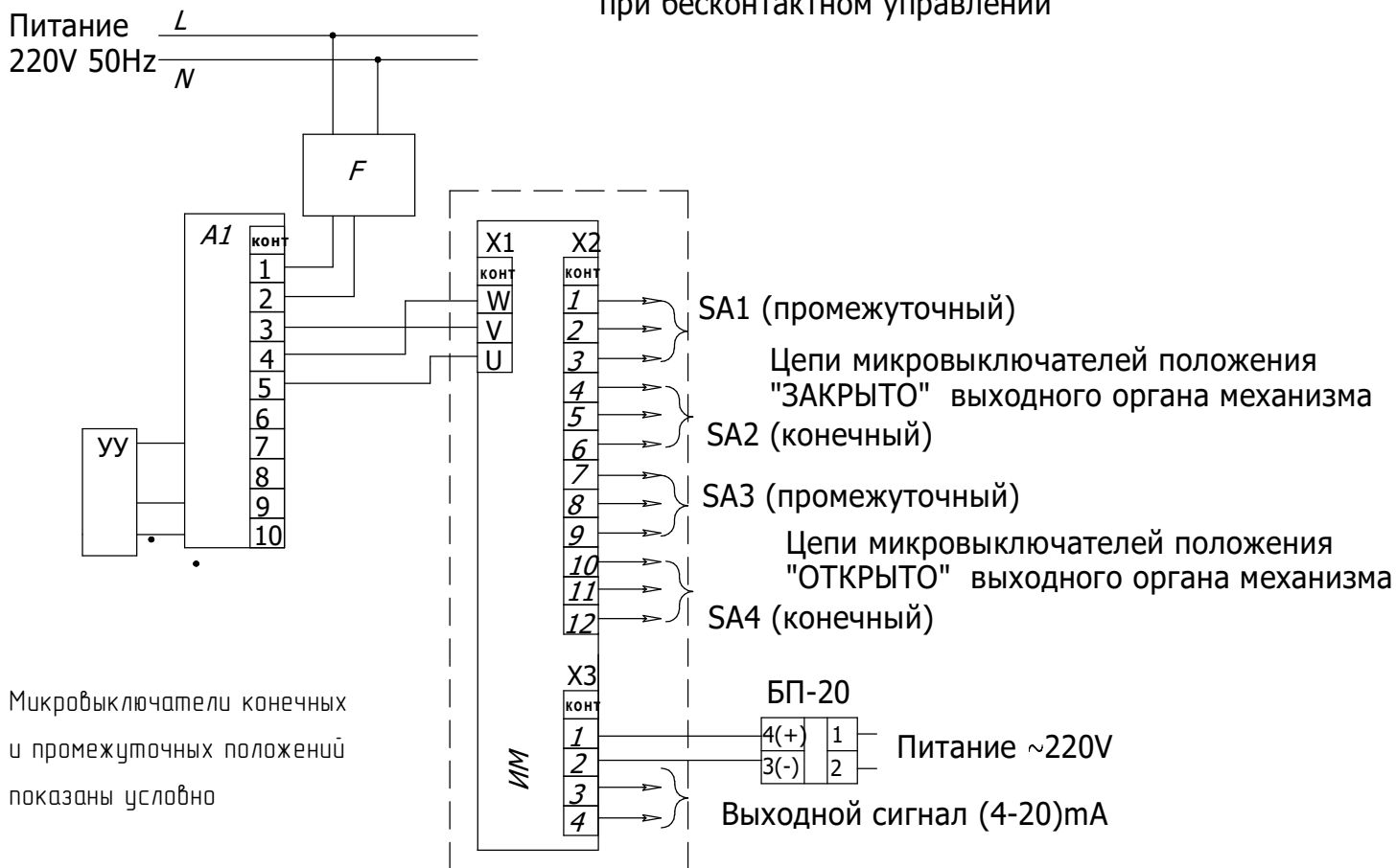
Рисунок В1.2 - Схема подключения механизма к сети 220V с блоком БСПТ-10АК при бесконтактном управлении
