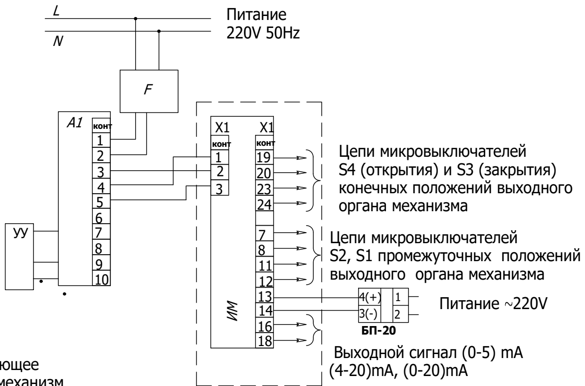
Рисунок В.2 - Схема подключения механизма к сети 220V с датчиком БСПТ-10М при бесконтактном управлении
