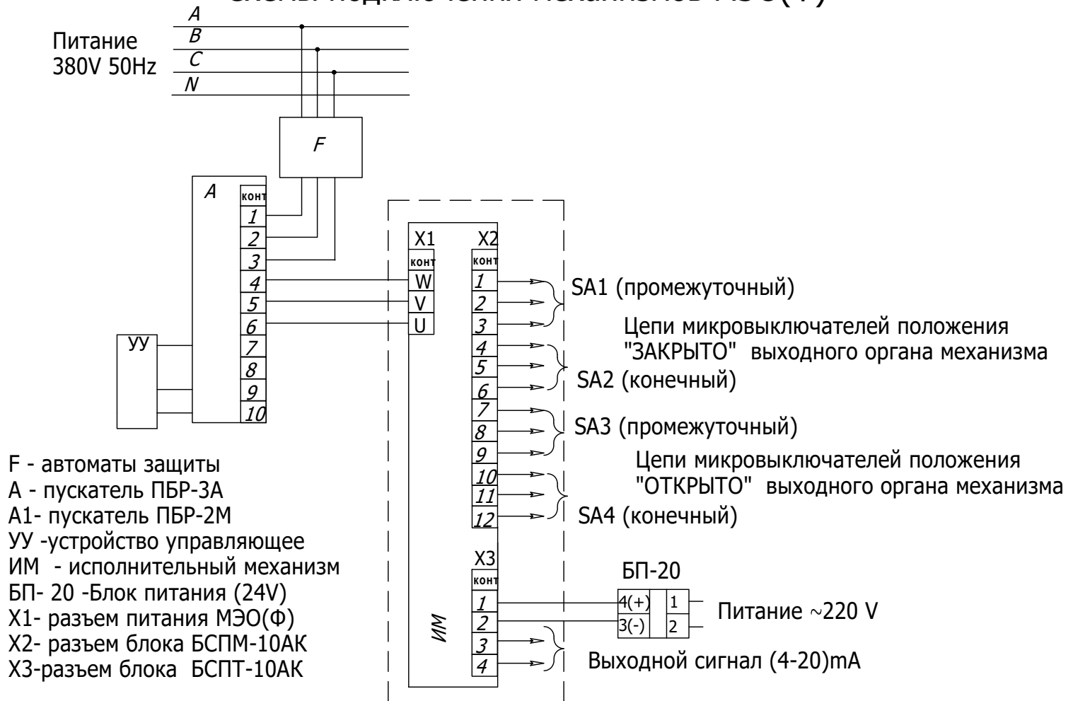
Рисунок В.1- Схема подключения механизма к сети 380V с блоком БСПТ-10АК при бесконтактном управлении
