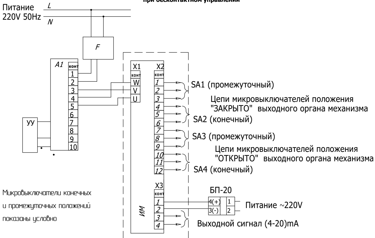
Рисунок В.2 - Схема подключения механизма к сети 220V с блоком БСПТ-10АК при бесконтактном управлении
