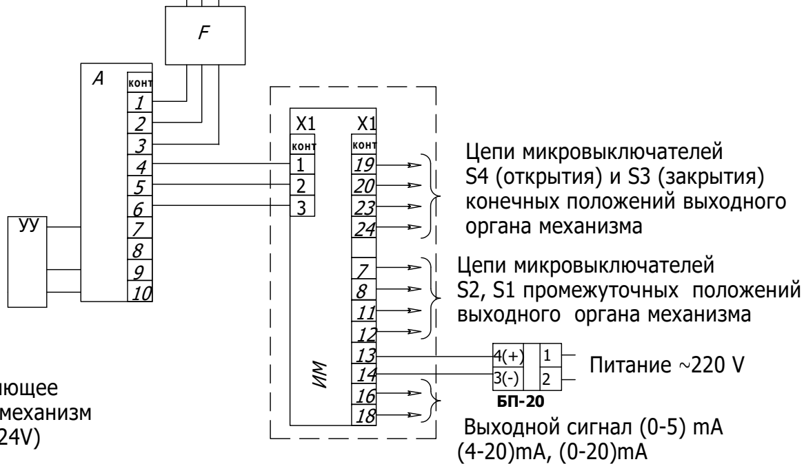
Рисунок В1.1- Схема подключения механизма к сети 380V с блоком БСПТ-10М при бесконтактном управлении
