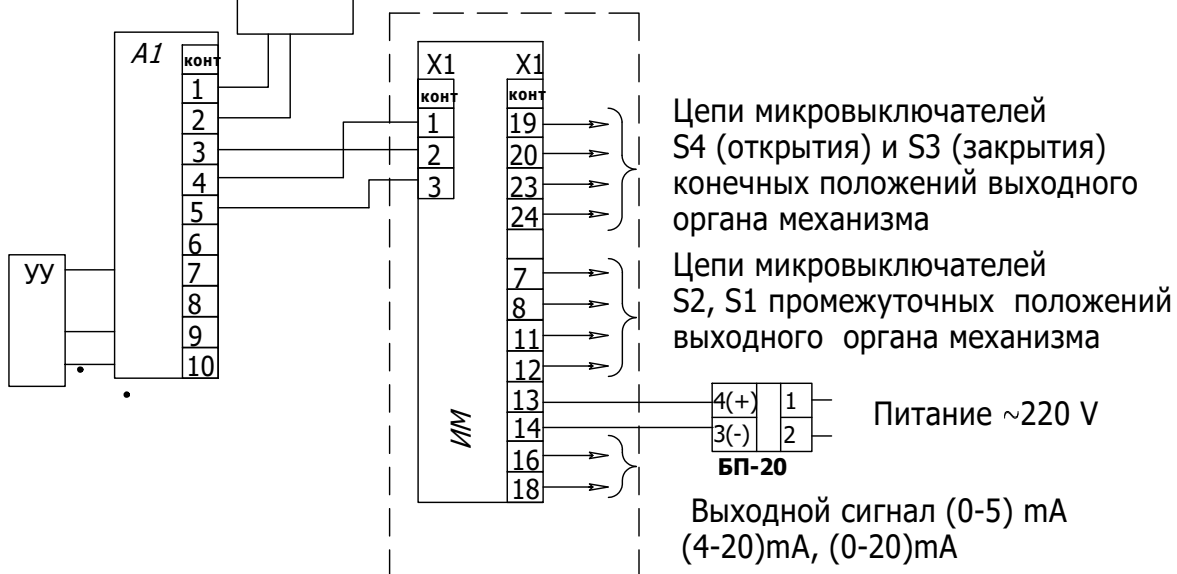
Рисунок В1.2 - Схема подключения механизма сети 220V с блоком БСПТ-10М при бесконтактном управлении
