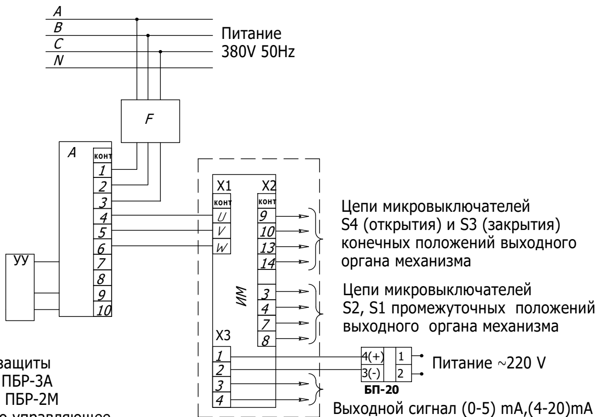
Рисунок В2.1- Схема подключения механизма к сети 380V с блоком БСПТ-10М при бесконтактном управлении
