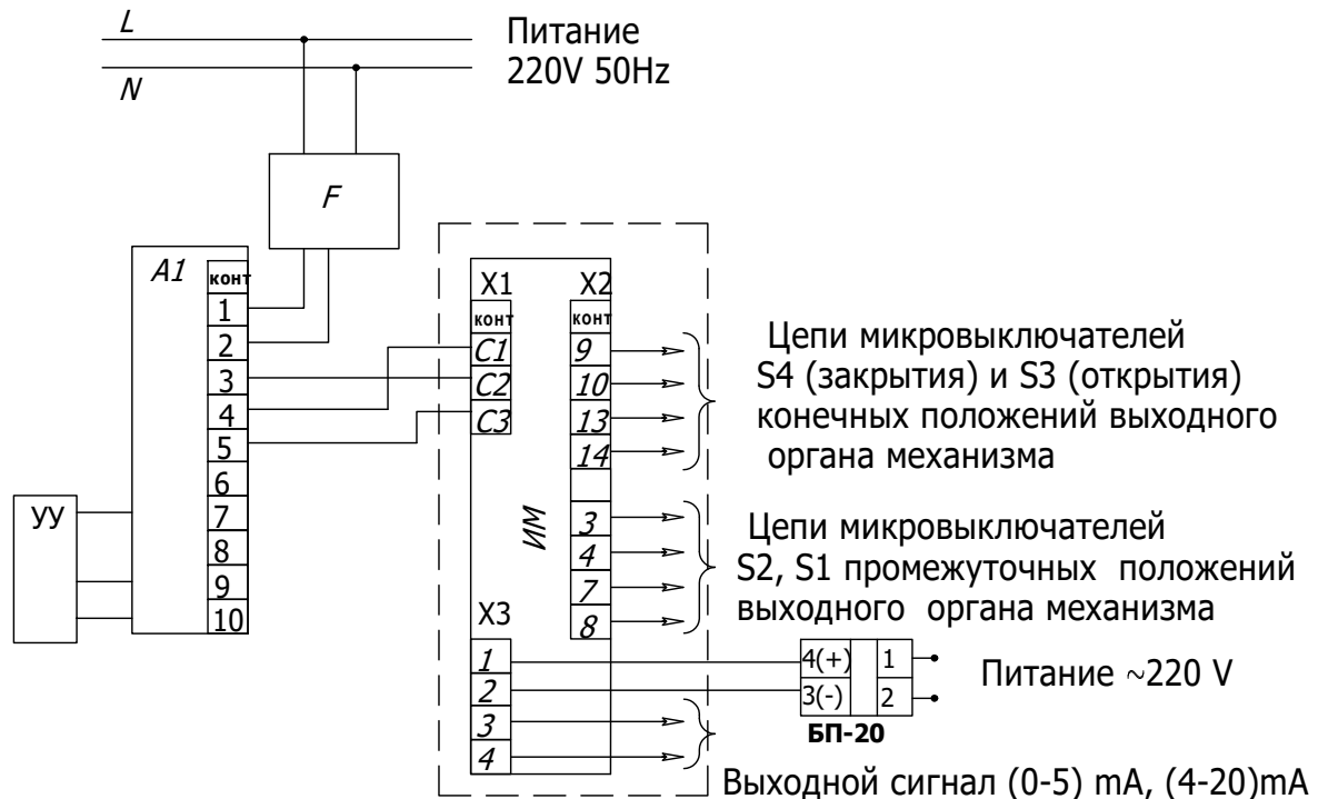
Рисунок В2- Схема подключения механизма к сети 220V с датчиком БСПТ-10М при бесконтактном управлении
