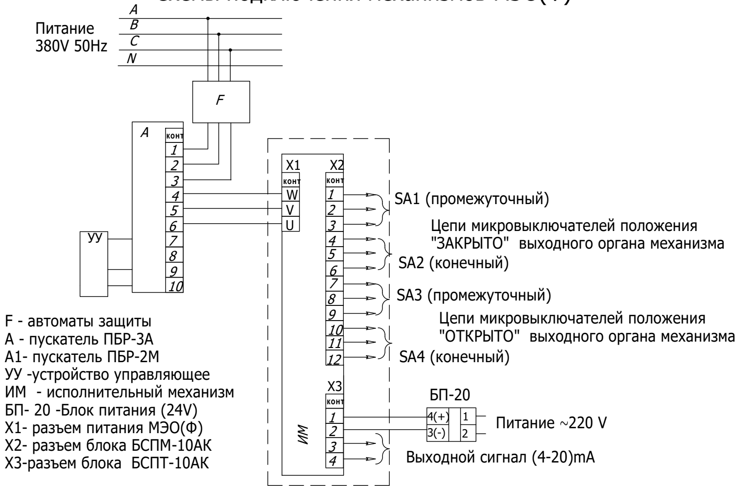
Рисунок В.1- Схема подключения механизма к сети 380V с блоком БСПТ-10АК при бесконтактном управлении
