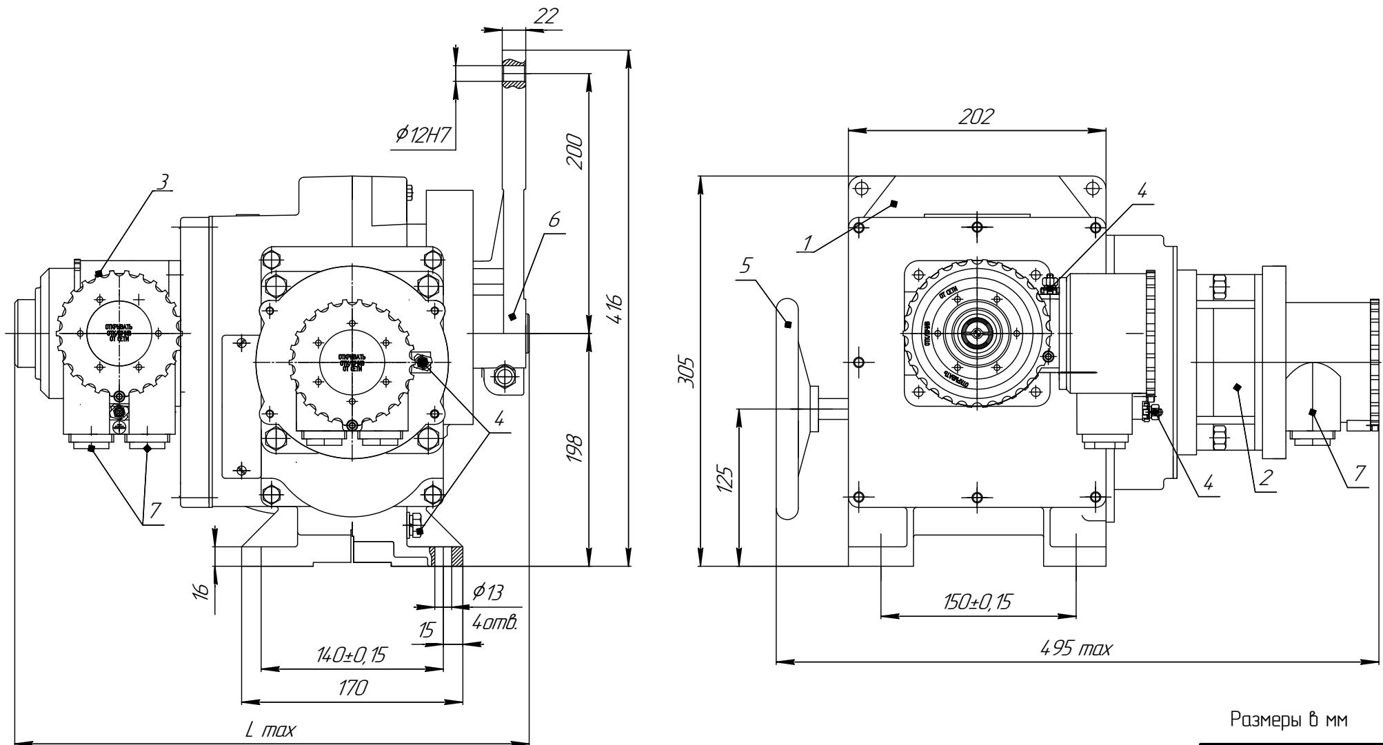
1 - редуктор; 2 - электроприбор; 3 - блок сигнализации положения БСП-ИСТ4 или БСПИ-ИВТ6;
