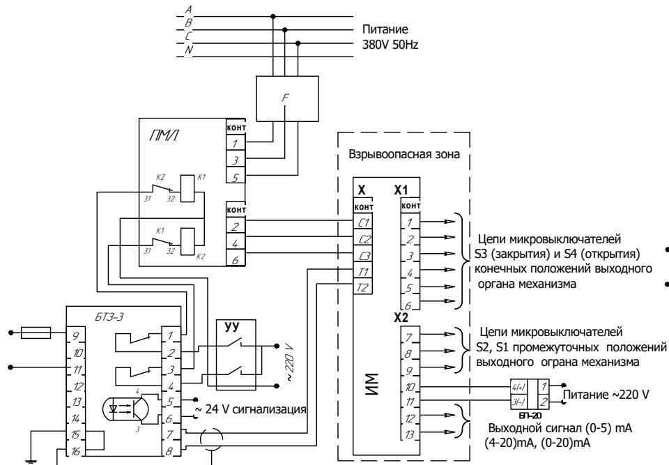
Рисунок Д.1 - Схема подключения механизма с блоком БСПТ
