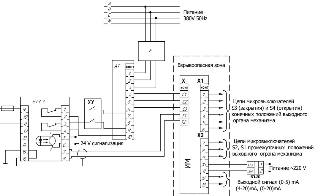
Рисунок Д.2 - Схема подключения механизма с блоком БСПТ
