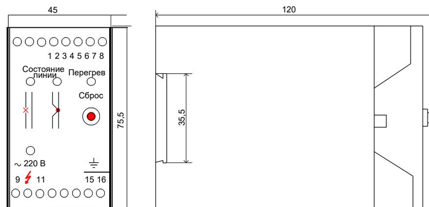
1,2,3,4 - клеммы для подключения цепей управления двигателем
