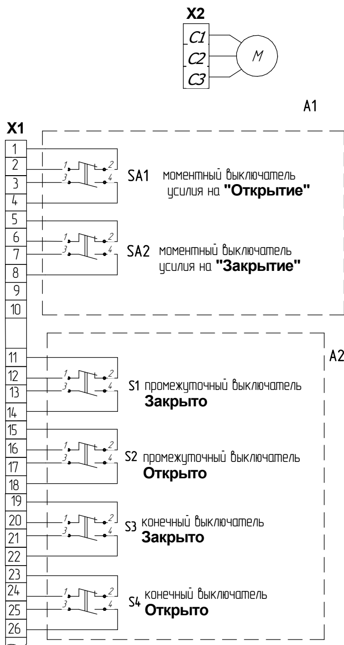
Рисунок Б.1 Схема электрическая механизма МЭП трехфазного исполнения с блоком БСПМ-10.
