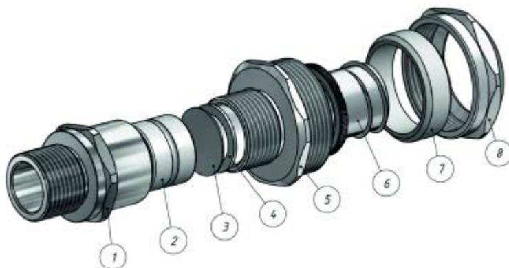
где: 1- корпус, 2 - кабель уплотнитель, 3 - заглушка, 4 - антифрикционное кольцо, 5 - нажимной штуцер, 6 - оконцеватель металлорукава, 8 – накидная гайка.
