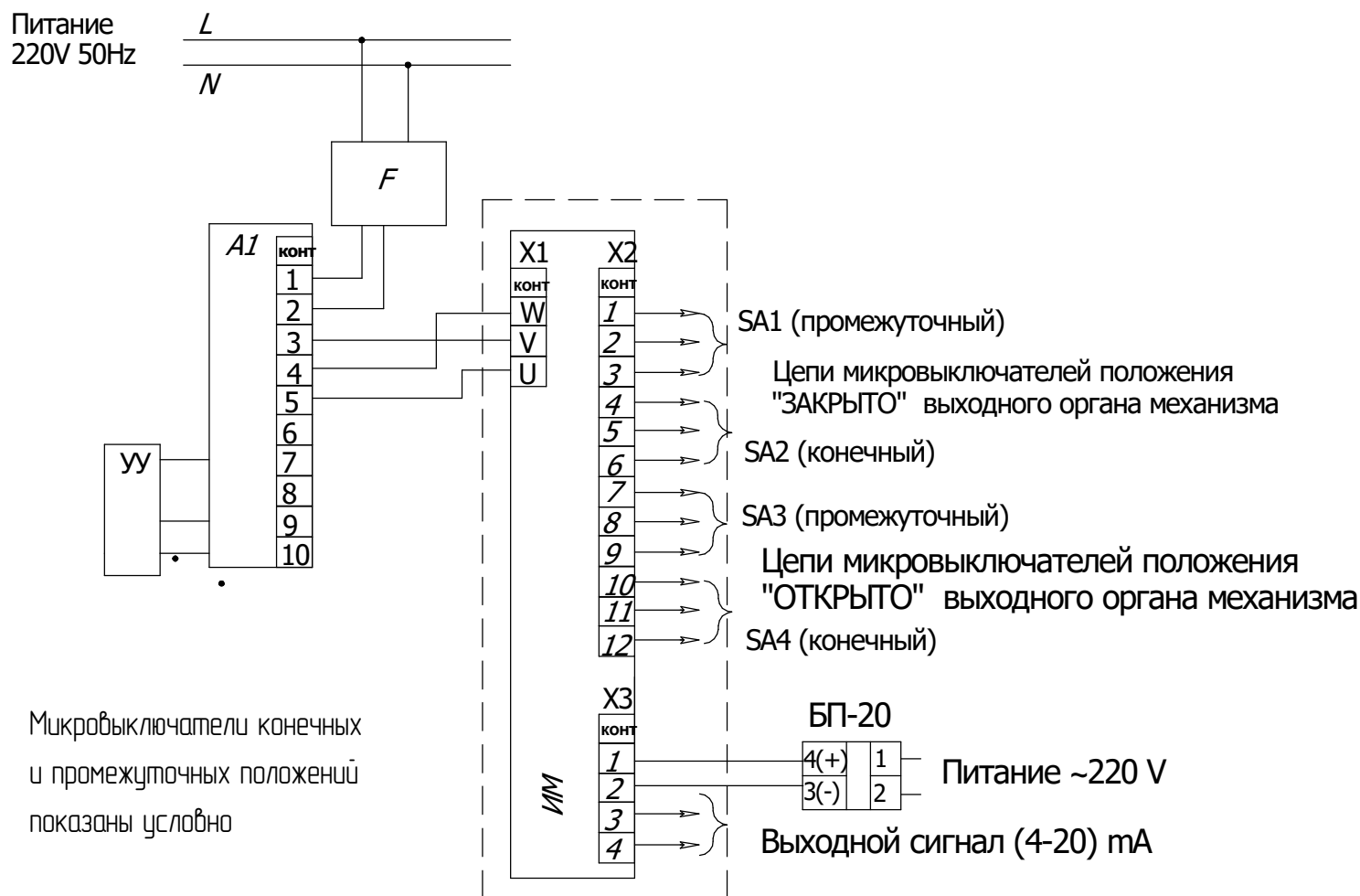
Рисунок В1.2 - Схема подключения механизма к сети 220V с блоком БСПТ-10АК при бесконтактном управлении
