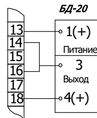
Рисунок Б.4-Схема механизма с блоком БД-20 Остальное см. рис. Б.1
