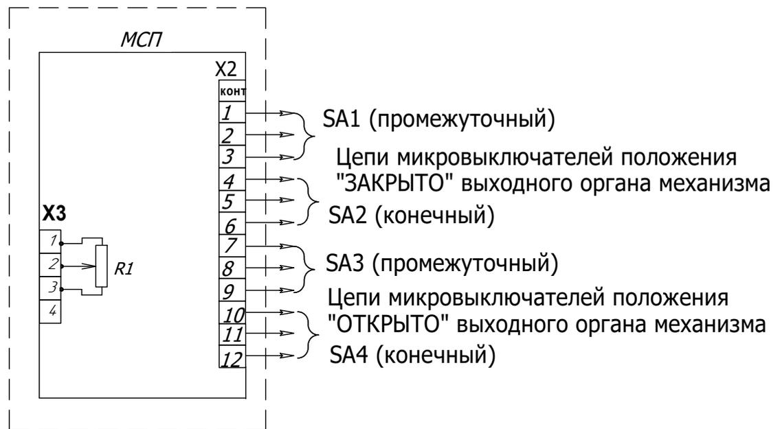
Рисунок Д2 – Схема проверки МСП с блоком БСПР-10АК
