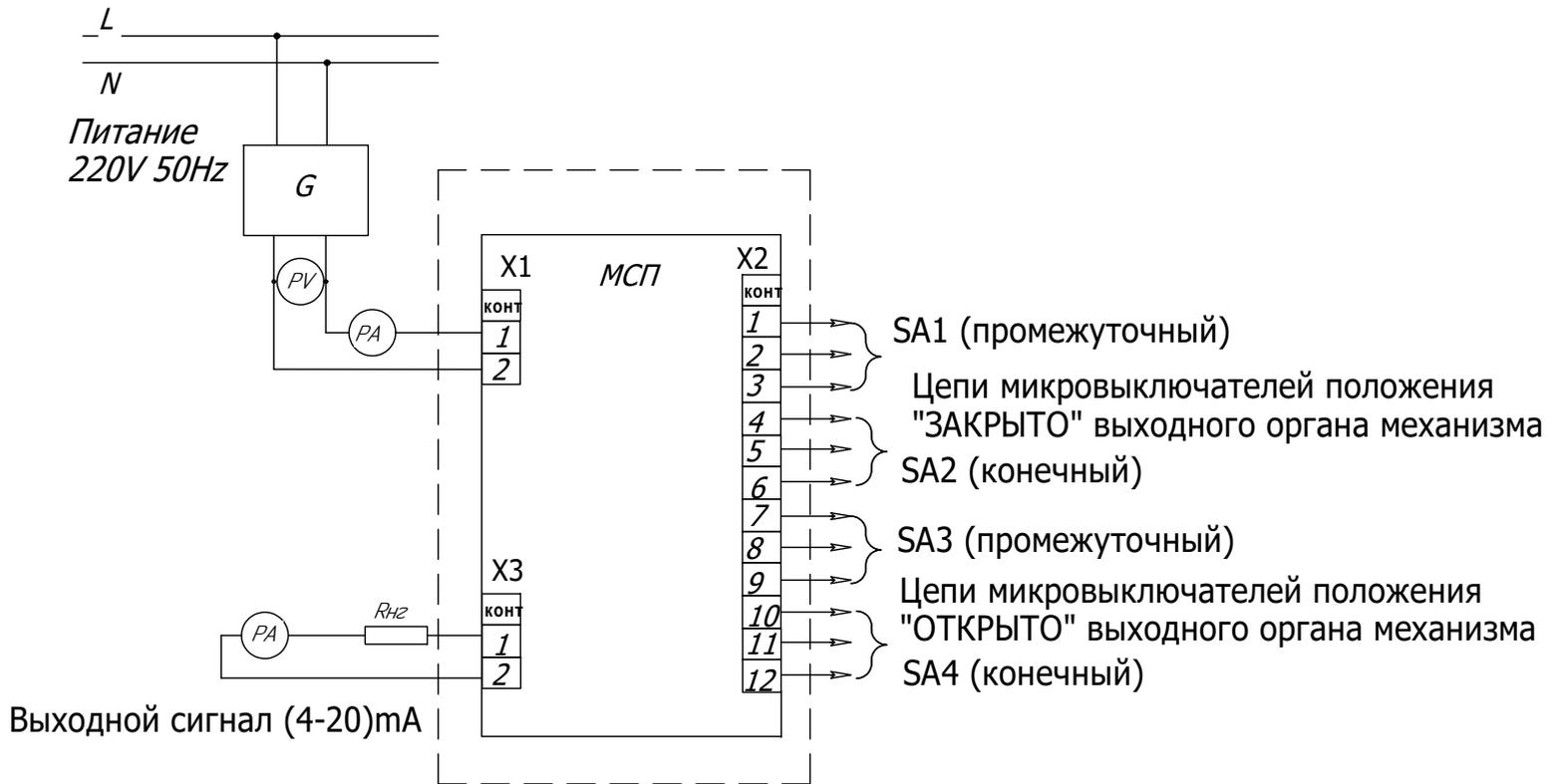
Рисунок Д1 – Схема проверки МСП с блоком БСПТ-10АК
