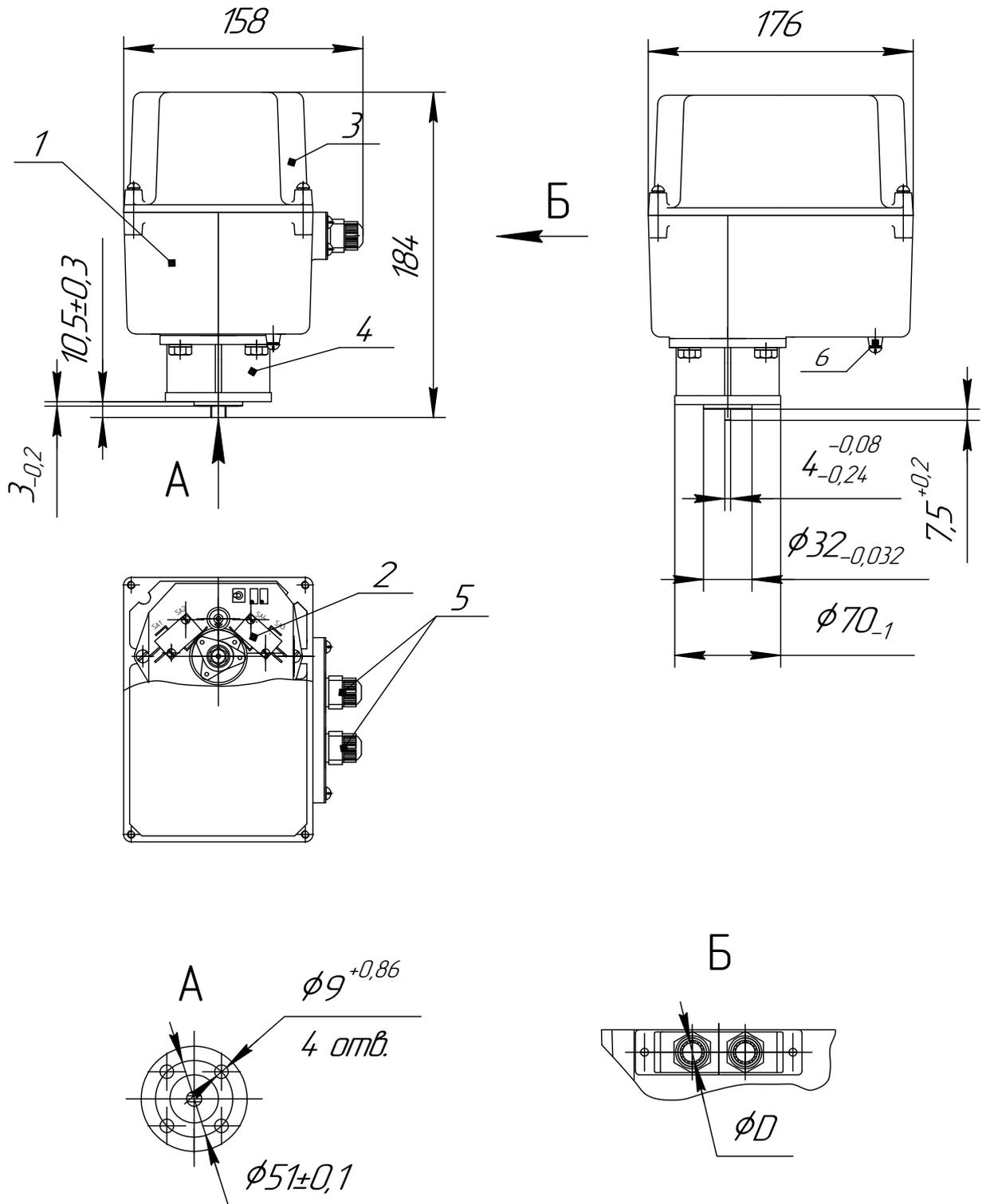
1 – редуктор, 2 – блок сигнализации положения, 3 – крышка, 4 – фланец,
