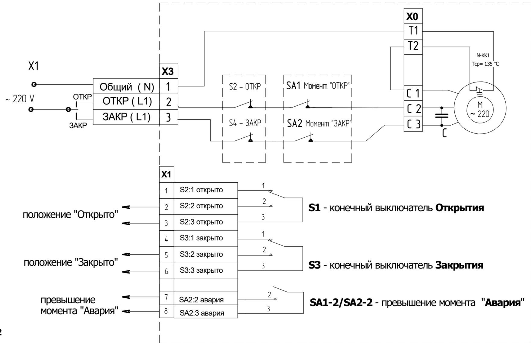
Рисунок Б.1 - Схема с блоком БСПМ-4
