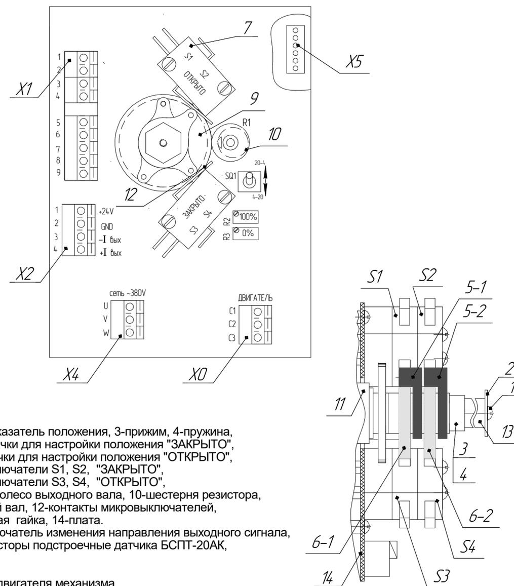
1- винт, 2- указатель положения, 3-прижим, 4-пружина, 5-1; 5-2-кулачки для настройки положения "ЗАКРЫТО", 6-1;6-2-кулачки для настройки положения "ОТКРЫТО", 7-микровыключатели S1, S2, "ЗАКРЫТО", 8-микровыключатели S3, S4, "ОТКРЫТО", 9-зубчатое колесо выходного вала, 10-шестерня резистора, 11-выходной вал, 12-контакты микровыключателей, 13-прижимная гайка, 14-плата.
