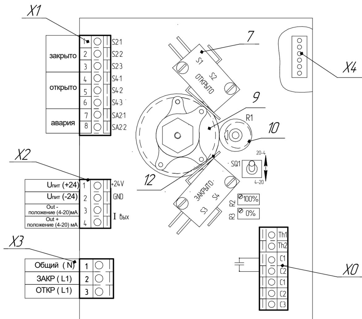
X0 – разъем подключения двигателя ДСР 110
