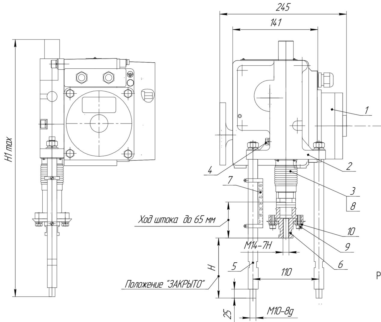
Рисунок А.1 – Механизм МЭПК-6300-14
