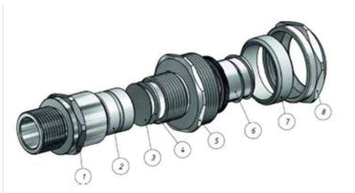
где: 1- корпус, 2 - кабель уплотнитель, 3 - заглушка, 4 - антифрикционное кольцо, 5 - нажимной штуцер, 6 - оконцеватель металлорукава, 8 – накидная гайка.
